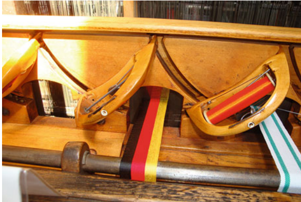
Abbildung 1.5 Detail eines Bandwebstuhls. (Foto: Thomas Möllers CC BY-SA 4.0)
